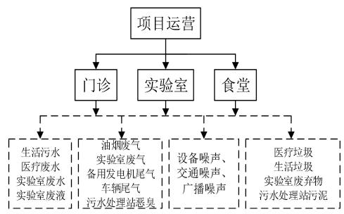
图 2.7-2 本项目改造后生产工艺流程及产污环节
