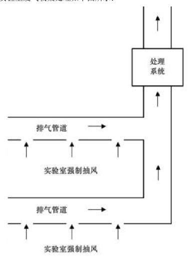
图 4.1-1 实验室废气收集处理示意图
