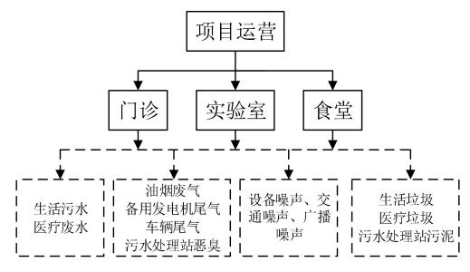
图 2.10-1 现有项目生产工艺流程及产污环节
